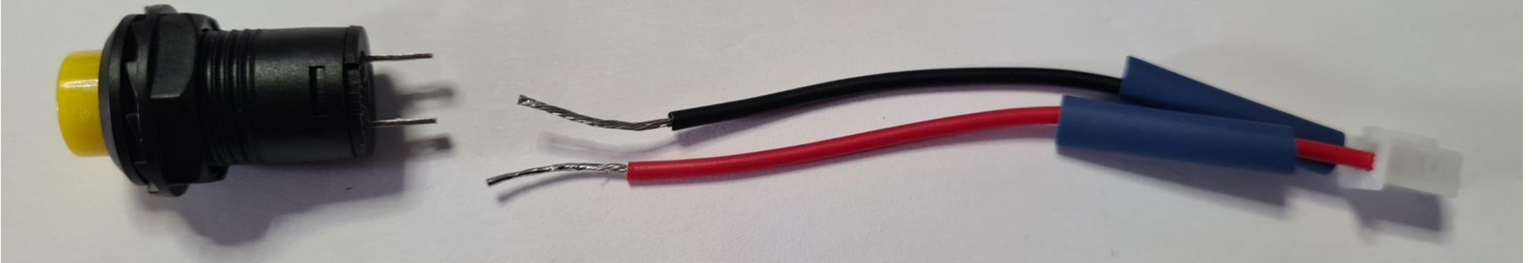
Die Füße der Schalter haben kleine Löcher. Hier können die verzinnten Kabel durchgefädelt werden.
