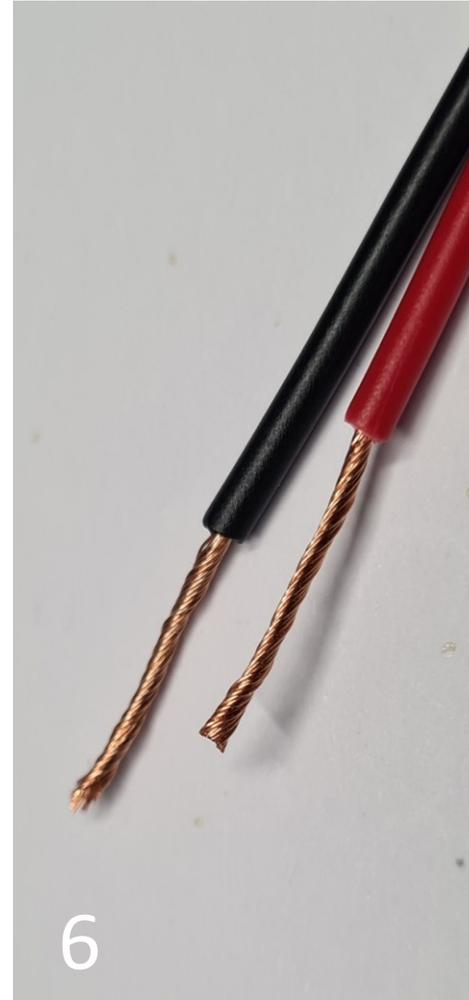
Mit Hilfe des LötKolbens und Lötzinn die verzwirbelten Drähte verzinnen
