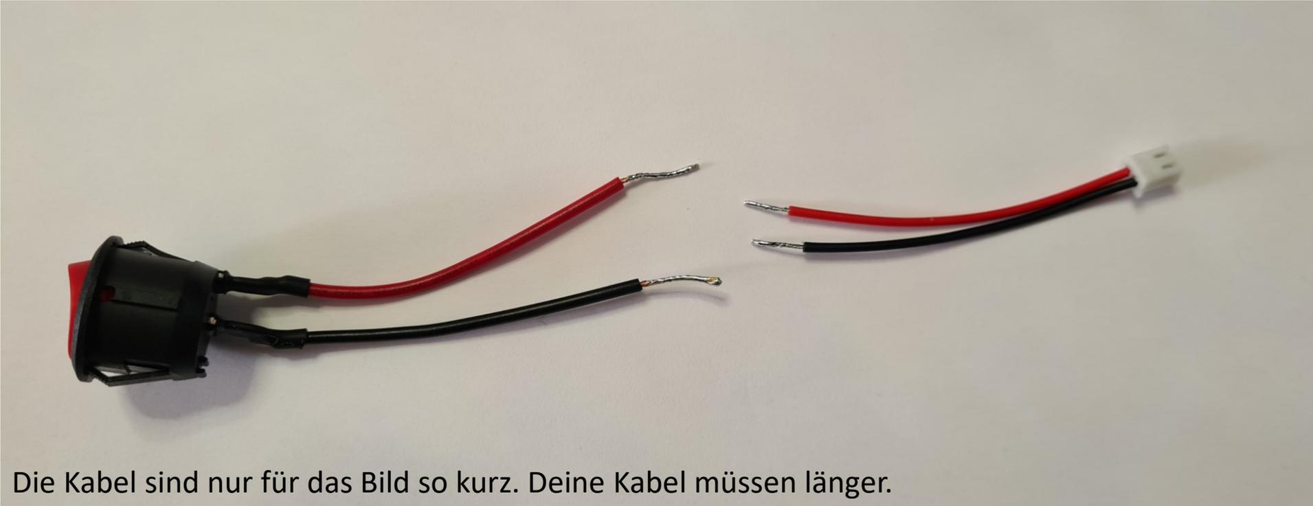
Die gekürzten Kabel vom Bauteil und die gekürzten Kabel vom Stecker werden nun miteinander verbunden.
