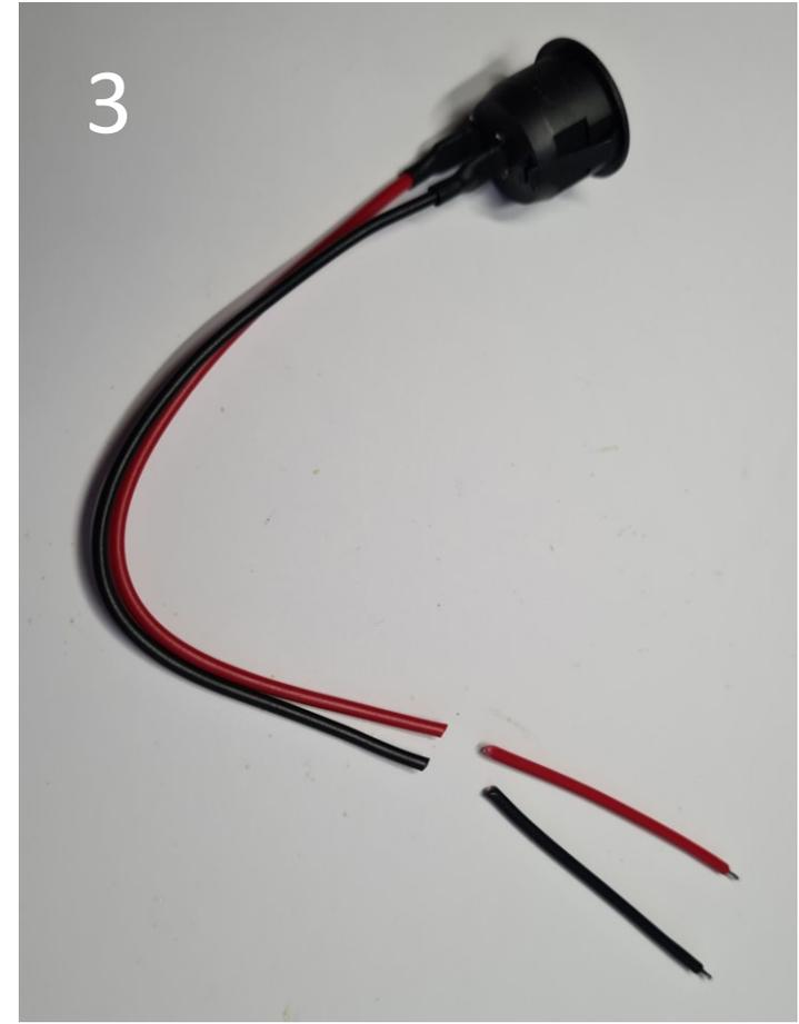
Etwa bei 2/3 der Länge den Draht mit dem Seitenschneider durchtrennen, **1/3 entfernen**
