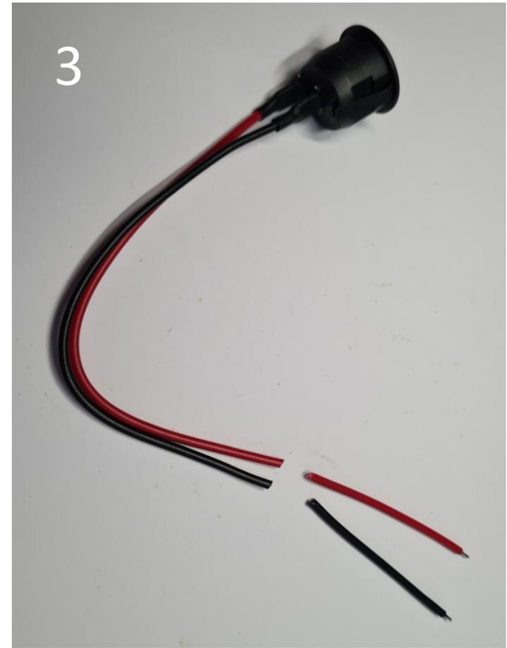
Etwa bei 2/3 der Länge den Draht mit dem Seitenschneider durchtrennen, **1/3 entfernen (ca. 5cm)**
