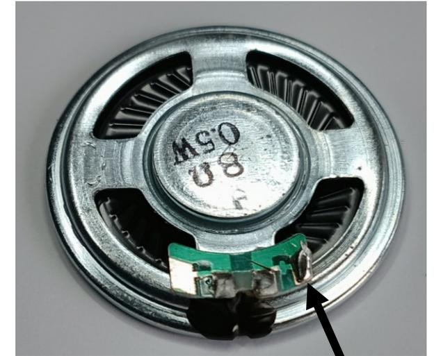
Du kannst schon ein bisschen Lötzinn auf die freie Stelle löten, dann geht das Anbringen des Kabels einfacher
