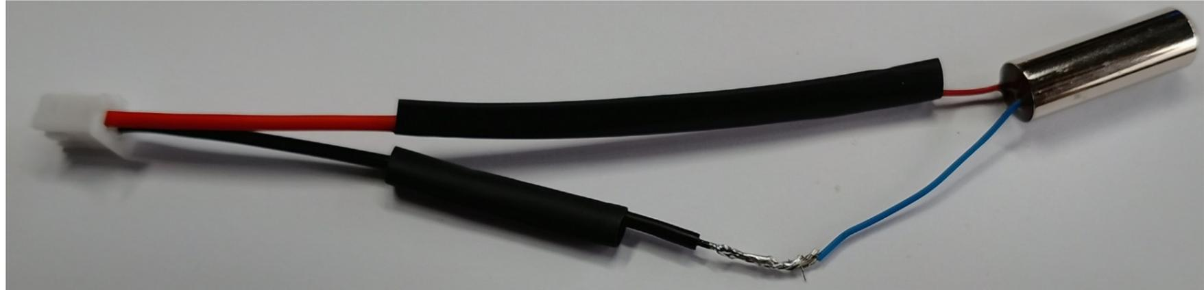
Danach die Schrumpfschläuche über den Lötstellen mit Hitze schrumpfen.
