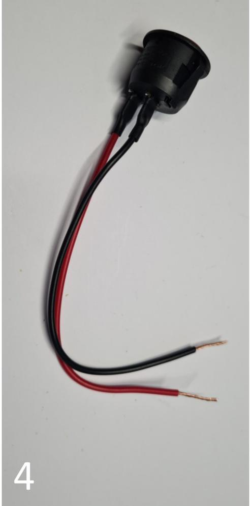
Die Enden der Drähte entweder mit dem Seitenschneider abisolieren oder mit der Abisolierzange
