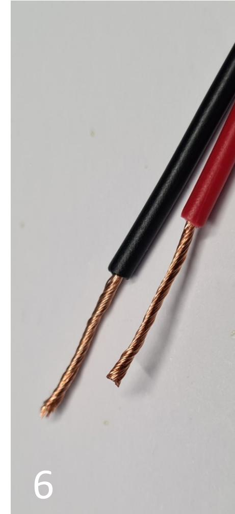
**Verzinnen:** Den Lötkolben in der Nähe der Isolierung an den Draht legen und gleichzeitig mit dem Lötzinn berühren. Das geschmolzene Lot mit dem Lötkolben zum Ende des Drahts verstreichen.
