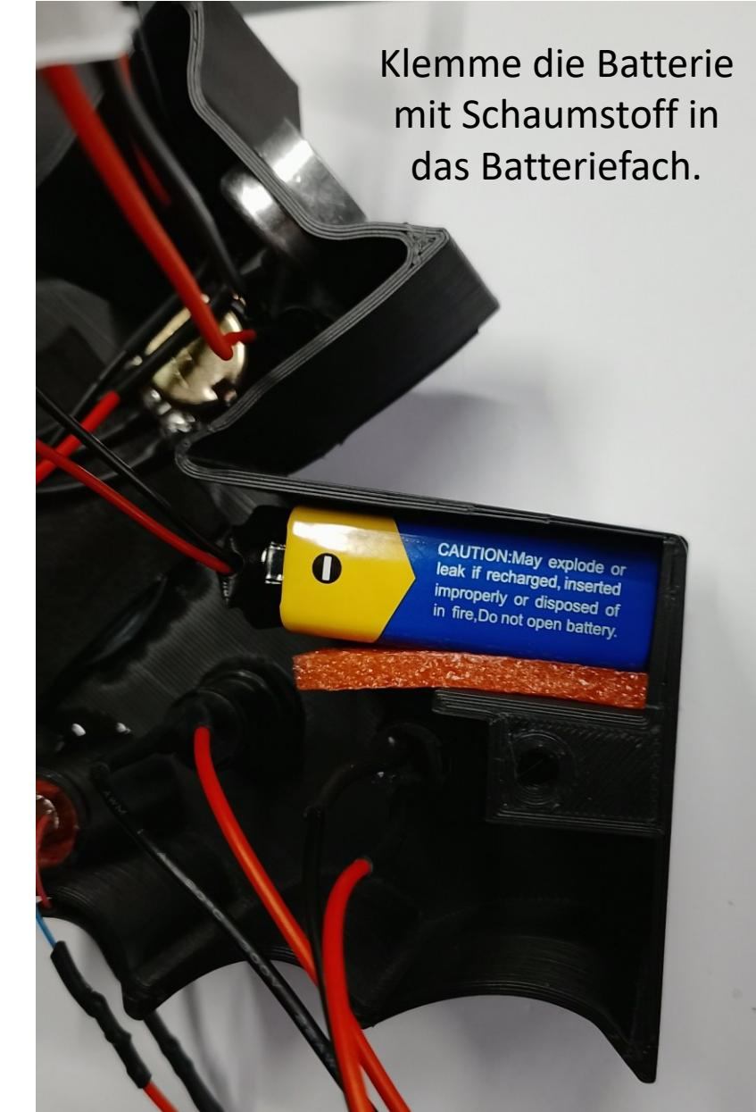
Klemme die Batterie mit Schaumstoff in das Batteriefach.
